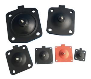
由于不同工况下将选用不同类型的阀门和材料,在选择阀体和隔膜之前,必须对每一个产品的运用进行分析,尤其针对化学医药方面的运用,和高温所导致的化学反应。通过有效的化学数据或专家认证,对材质的适宜性进行检测。以此确保产品的使用安全性和长期有效性。软性弹性材料制成的隔膜对于那些被纤维团,固体颗粒,催化物等污染的工作介质不会产生敏感反应,一般来说也不会影响到阀门的工作和密封。根据工作或消毒的温度,以及工作介质的化学特性可以选择不同的隔膜材料。
